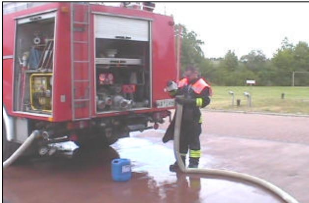
Jetzt wird die B-Leitung an den Füllstutzen des Tanks angeschlossen und die Pumpe in Betrieb genommen. Das Wasser wird für mindestens 30 min. im Kreislauf gefahren. Dadurch wird eine optimale Verteilung und Wirkung des Desinfektionsmittels erreicht.
