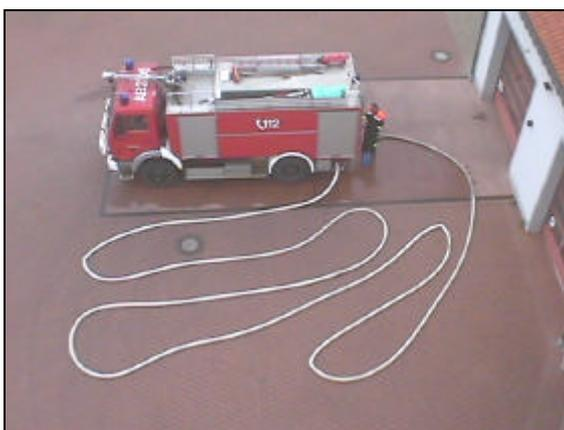
Für die Desinfektion muss das Trinkwasser im Kreislauf gefahren werden. Hierzu werden drei B-Druckschläuche zusammen gekuppelt und am Abgang sowie an dem Füllstutzen des Tanks angeschlossen. Das Wasser wird dann über den Abgang zurück in den Tank gepumpt und somit ein Kreislauf hergestellt. Die desinfizierten B-Druckschläuche werden dann zum Befüllen und Entleeren des Tanklöschfahrzeuges mit Trinkwasser benutzt.
